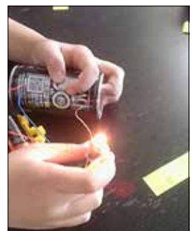
【図6 削った空き缶は電気を通した。】
