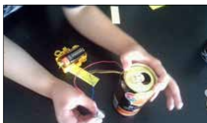
【図4 空き缶は素材がアルミニウムや鉄でも電気を通さなかった。】
